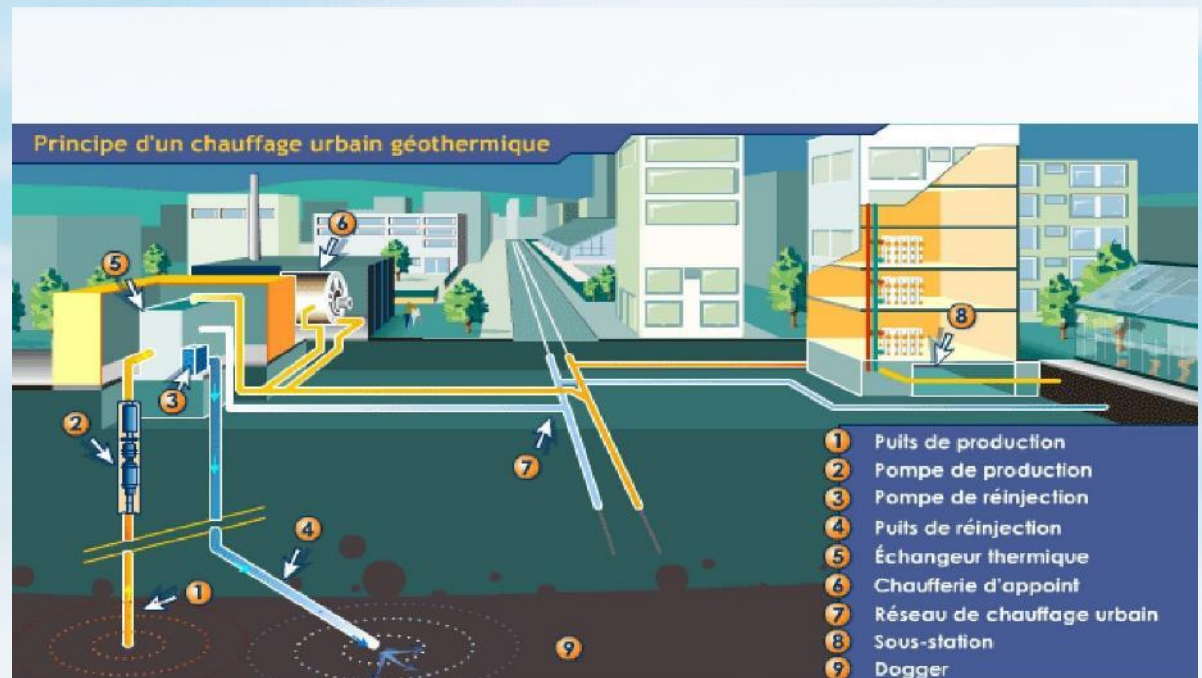
Schéma de principe d'une installation destinée à exploiter de la chaleur pour le chauffage urbain
