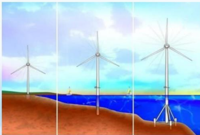
1985 : Ø 15 m 1995 : Ø 70 m 2005 : Ø 110 m P = 50 kW P = 1500 kW P = 4000 kW
